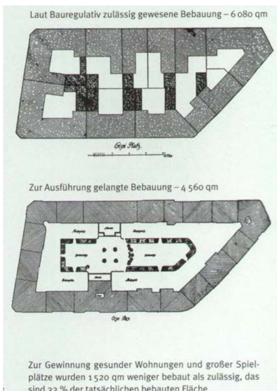
Die praktischen Auswirkungen der neuen Baugesetzgebung auf den genossenschaftlichen Wohnungsbau: Vergleichende Darstellung einer Wohnbebauung nach der alten und der neuen Baugesetzgebung. Vergleiche beide Abbildungen.
